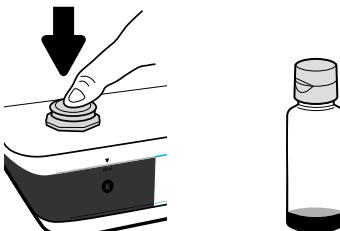
Вставьте бутылку в отверстие емкости. Заполните емкость чернилами до линии. Плотно закройте емкость, надавив на пробку.
