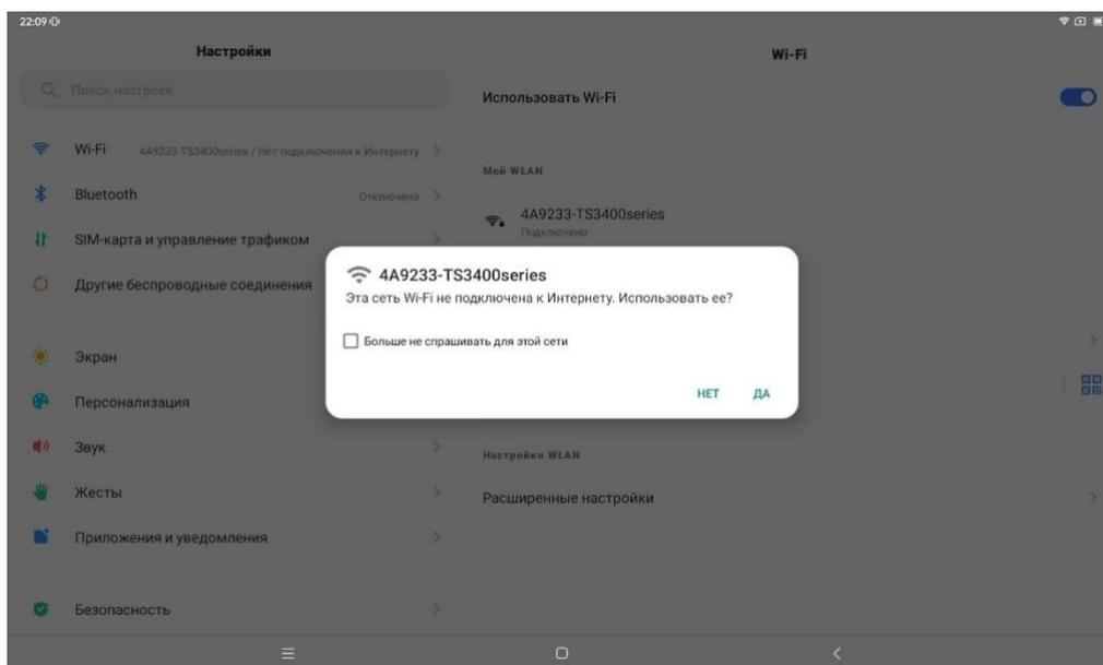
С интернетом планшет связан сигналом 4G, который идёт на вышку оператора связи. С принтером планшет связан сигналом Wi-Fi, который распространяется в комнате квартиры и на расстоянии не более 100 метров от неё. Это 2 разных сигнала. Сигнал Wi-Fi действительно не подключен к интернету, поэтому кликаем "Да" и не обращаем на это внимание.
